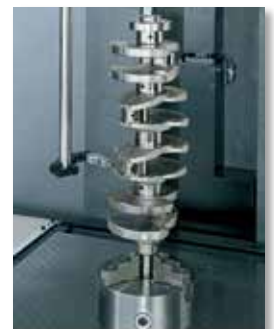
シリンダブロックやクランクシャフトの測定例
