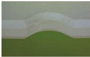
SiC、Sapphire、脆性材料のノッチ研削
