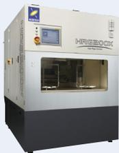
SiC / GaN基板などの硬脆性材料の研削が可能
